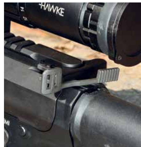
Le levier d'armement se manœuvre facilement car l'oculaire de la lunette laisse un espace suffisant.
