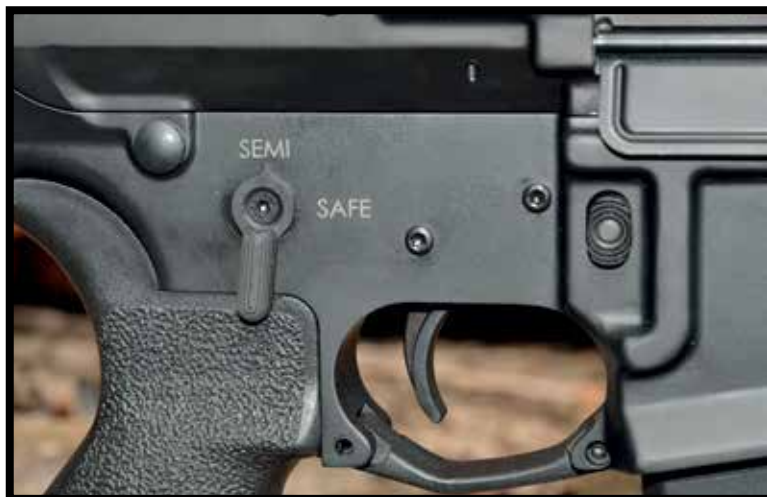
Le levier basculant de sûreté ambidextre vu côté droit.
