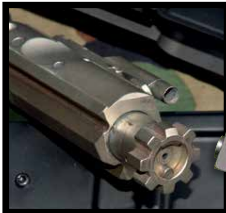
La tête de la culasse rotative dans son transporteur avec ses 7 tenons de verrouillage, l'éjecteur et la griffe de l'extracteur bien visibles.
