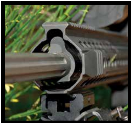
Le garde-main ne touche pas au canon qui bénéficie d'un minimum de contraintes mécaniques.
