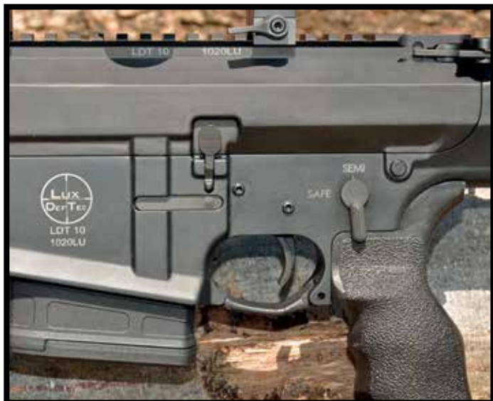
Côté gauche du boîtier avec la sécurité rotative à deux positions et le poussoir de l'arrêt de culasse. La filiation avec l'AR10/15 est évidente.
