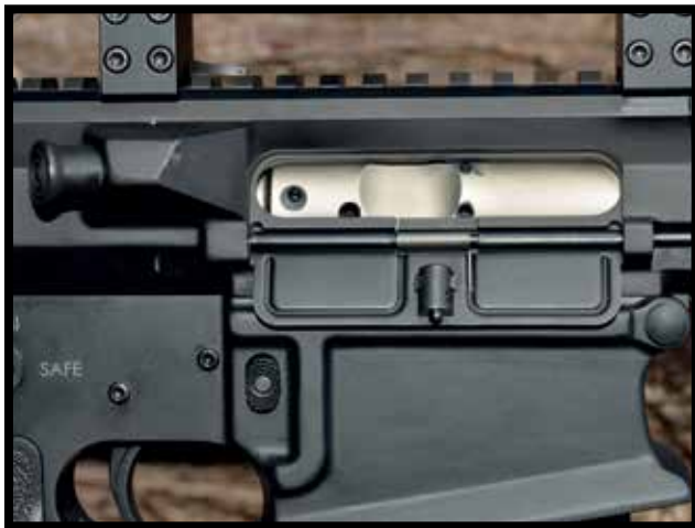
Gros plan du boîtier côté droit, fenêtre de protection de la fenêtre d'éjection ouverte et culasse verrouillée.
